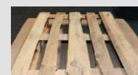
Niedopuszczalny, niezgodny z Regulaminem Technicznym EPAL element konstrukcyjny, np. element niewymiarowy, spróchniały, oflisy
